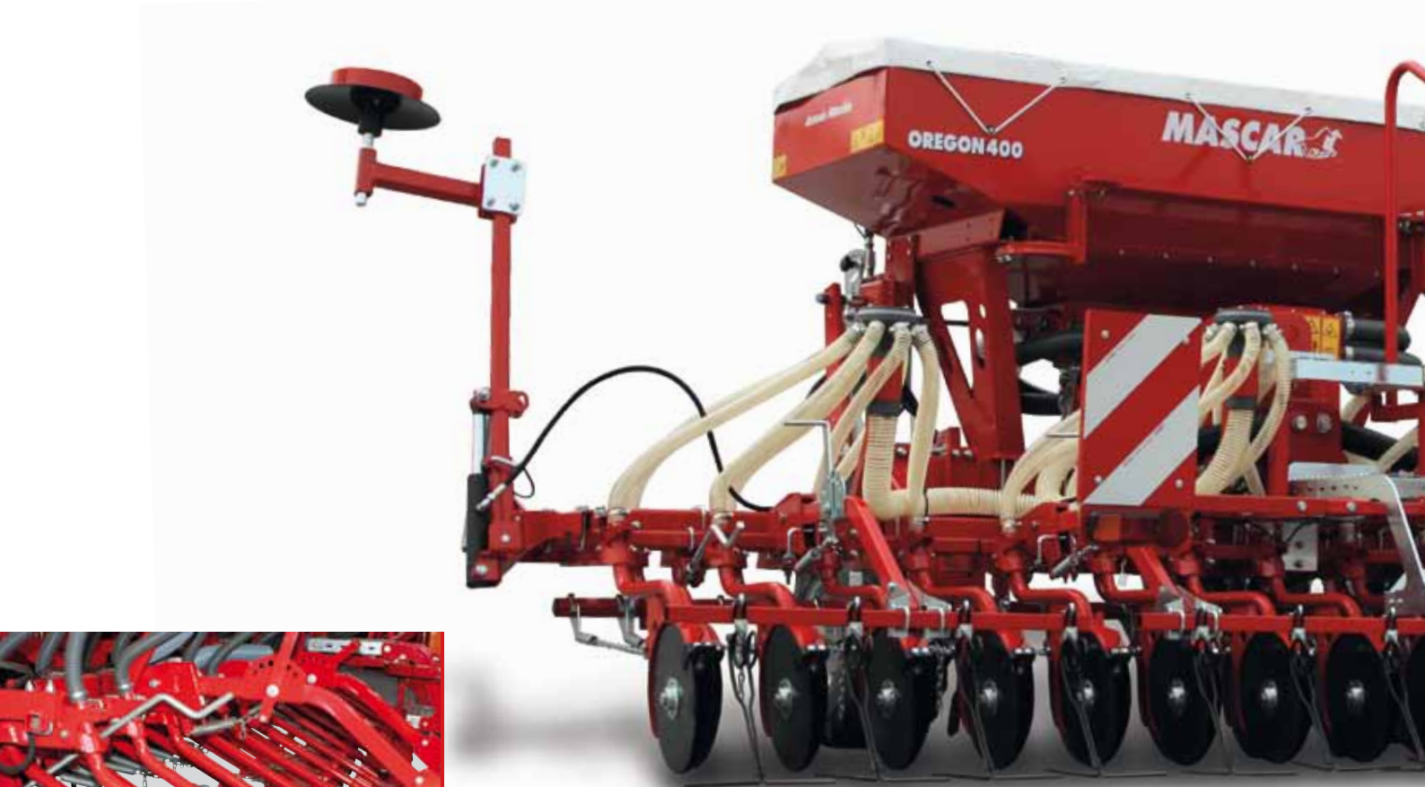
Assolcatore a scarpetta Suffolk coulter Stiefelschar Redlica stopkowa Сошник в виде плужка
